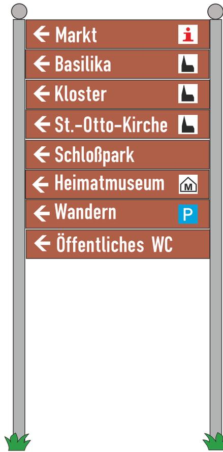
Aufsteller mit rund Aluminiumsäulen und Kugelaufsatz
